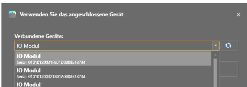
Nach dem ein Gerät aus der Liste ausgewählt worden ist, klicken Sie auf das "OK" Button, somit wird das ausgewählte Gerät in den Projektbaum übernommen. Im Eigenschaftsmenü wird jetzt die Seriennummer angezeigt und die gelbe Markierung entfernt.
