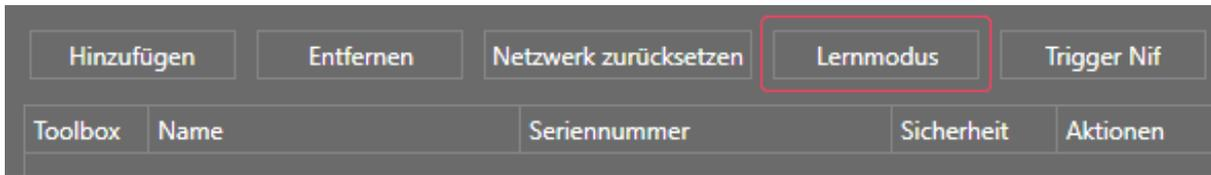
Nachdem der Lernmodus gestartet ist, wird der DSK (Device-Specific key) angezeigt. Der Lernmodus kann nur gestartet werden, wenn keine Z-Wave-Slavegeräte mit dem Radio Server resp. Smart Server verbunden sind.
